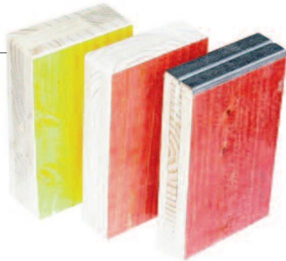
**3-Schichten-Schalungsplatten** mit oder ohne Kantenschutz bestehen aus 3 gleich starken Schichten. Die beiden längslaufenden Außenschichten und die querliegende Mittelschicht sind miteinander wasserfest verleimt. Ein Quellen oder Schwinden ist durch diese Konstruktion fast ausgeschlossen. Die Platten sind somit in Bezug auf Länge und Breite praktisch maßhaltig. Bei den 3-Schichten-Schalungsplatten mit oder ohne Kantenschutz sind die Außenflächen kunstharz vergütet und alle Kanten versiegelt.
