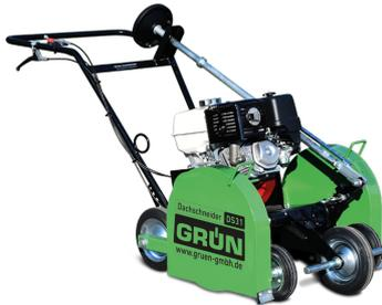
Das robuste, leistungsstarke Gerät mit 11 PS 4-Takt-Benzinmotor. Doppelte Schneidleistung durch 2 Schlagmesser. Die vertikal eingesetzten Schlagmesser mit Hartmetallbestückung werden über Keilriemen angetrieben. Die Schneidtiefe kann stufenlos verstellt werden.
