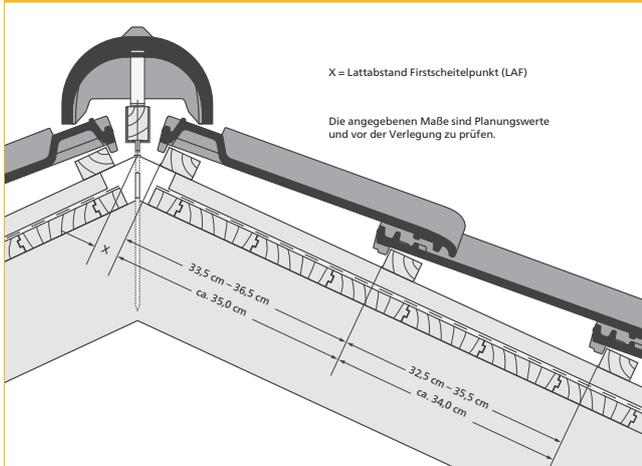
**Firstziegel Nr. 15 mit Firstanschlussziegeln**
