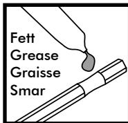
HEXAFIX spojka mora uvijek biti čista i pokretljiva. Nakon završetka posla izvadite miješalo iz spojke. Šesterokutnu prihvativnik spojke redovito podmazujte prikladnim mazivom. Čistite ventilacijske otvore kako biste osigurali dostatno hlađenje. Zatvoreni ventilacijski otvoridovode do uništenja stroja.
