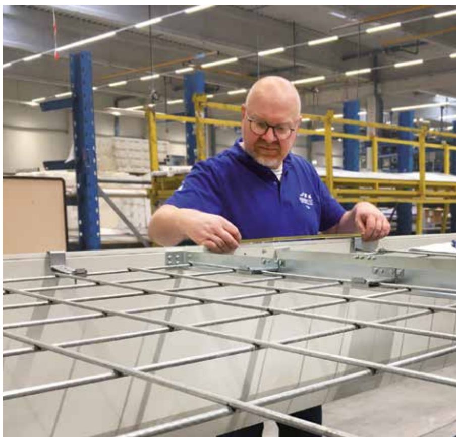
Das Durchsturzgitter ist einfach von einer Person zu montieren.
