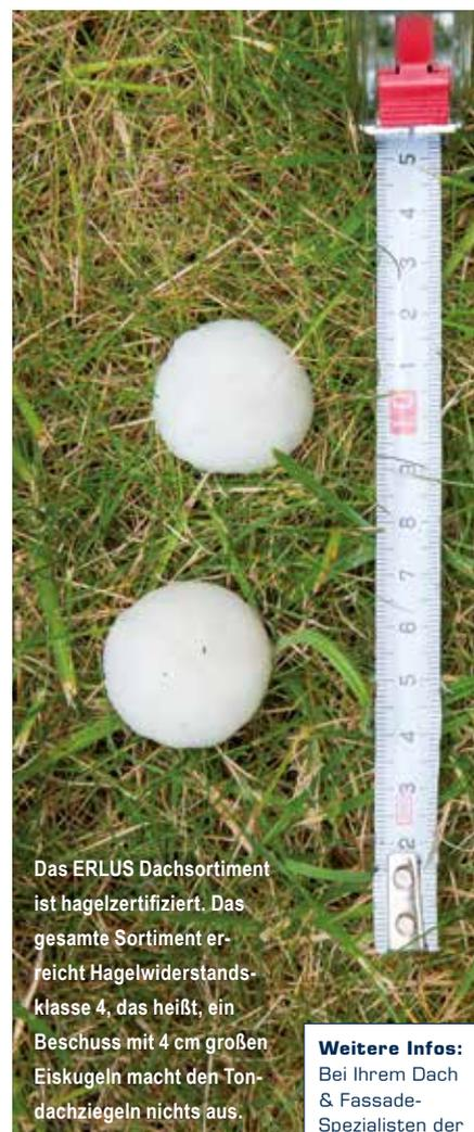
Das ERLUS Dachsortiment ist hagelzertifiziert. Das gesamte Sortiment erreicht Hagelwiderstandsklasse 4, das heißt, ein Beschuss mit 4 cm großen Eiskugeln macht den Tondachziegeln nichts aus.
