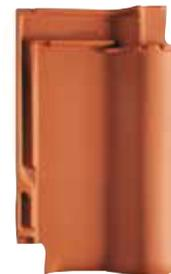
Flachdachziegel wie das Modell Futura von Creaton können mit wasserdichtem Unterdach bei einer Dachneigung bis 7° eingesetzt werden.
