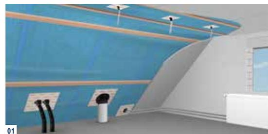
Mit den selbstklebenden Luftdichtmanschetten können komplizierte Abdichtungssituationen einfach und sicher abgedichtet werden.
