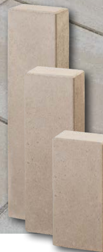
Antaria®-Palisaden, einfarbig, betonglatte Oberfläche, Kopf gefast 5 x 5 mm, Format: 18,75 x 12 cm, Höhen: 40 cm, 60 cm und 80 cm
