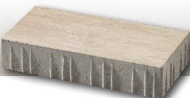
Antaria®-Pflaster, edle streifige Nuancierung, betonglatte Oberfläche, im verlegten Zustand nicht sichtbare, umlaufende Verbundnocken, geeignet für überwiegend Pkw- und gelegentlichen Lieferverkehr, Format: 40 x 20 x 8 cm
