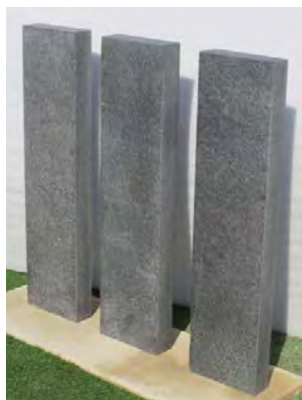
Gabbro-Stelen 8x25x100 cm, Star Galaxy schwarz, allseitig gesägt, gestrahlt+gebürstet, Kanten leicht gefast
