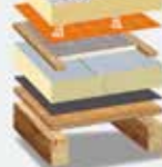
Schritt 4 Aufsparrendämmung BauderECO S aufbringen
