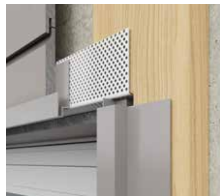
Die Edelstahlklammer kann flexibel auf der Unterkonstruktion befestigt werden. So sind die Paneele auch im Anschluss z. B. an Fenster- oder Türleibungen einfach sicher zu montieren. Spezielle Anfangs-, Eck- und Abschlussprofile sind passgenau und farblich abgestimmt. (Bild: Swisspearl®)
