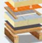
Schritt 5 Verlegung der Konter-/Dachlattung / Bedachung
