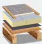
Schritt 2 Zwischen alte Konterlatten Dämmplatten BauderPIR FATE einlegen
